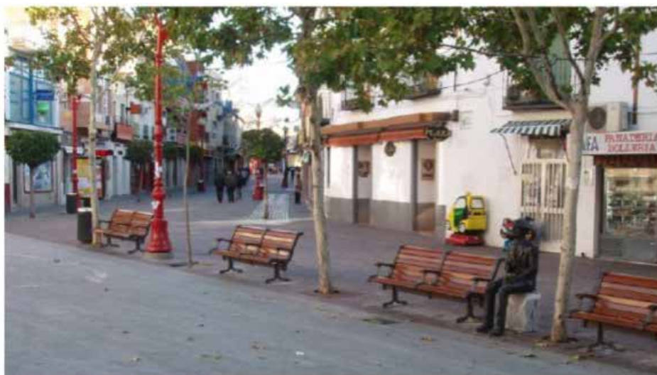
Imagen 07. Disposición de mobiliario urbano alineado. Los bancos disponen de una zona de estancia anexa a los mismo que permite el acercamiento de usuarios de sillas de ruedas, carritos de bebé, etc.
